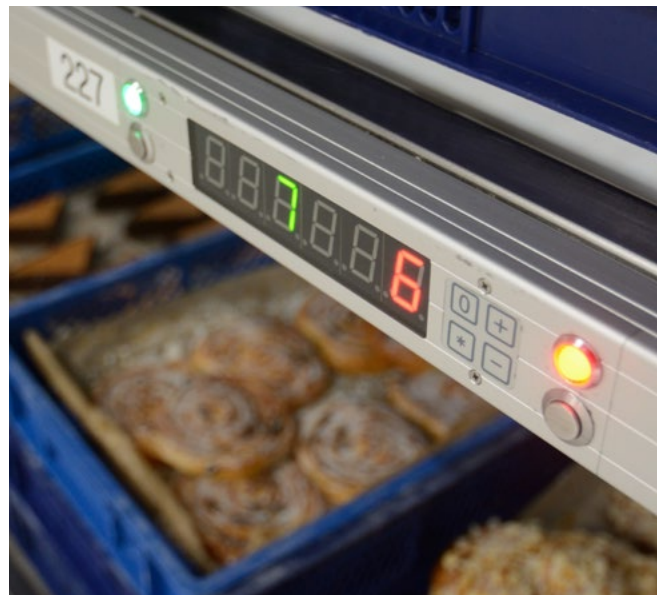
Rot zeigt die Menge für Produkt 1 an, grün die Menge für Produkt 2. Links von der Anzeige der Bestätigungsknopf, rechts die Möglichkeit, die Mengenangaben zu verändern
